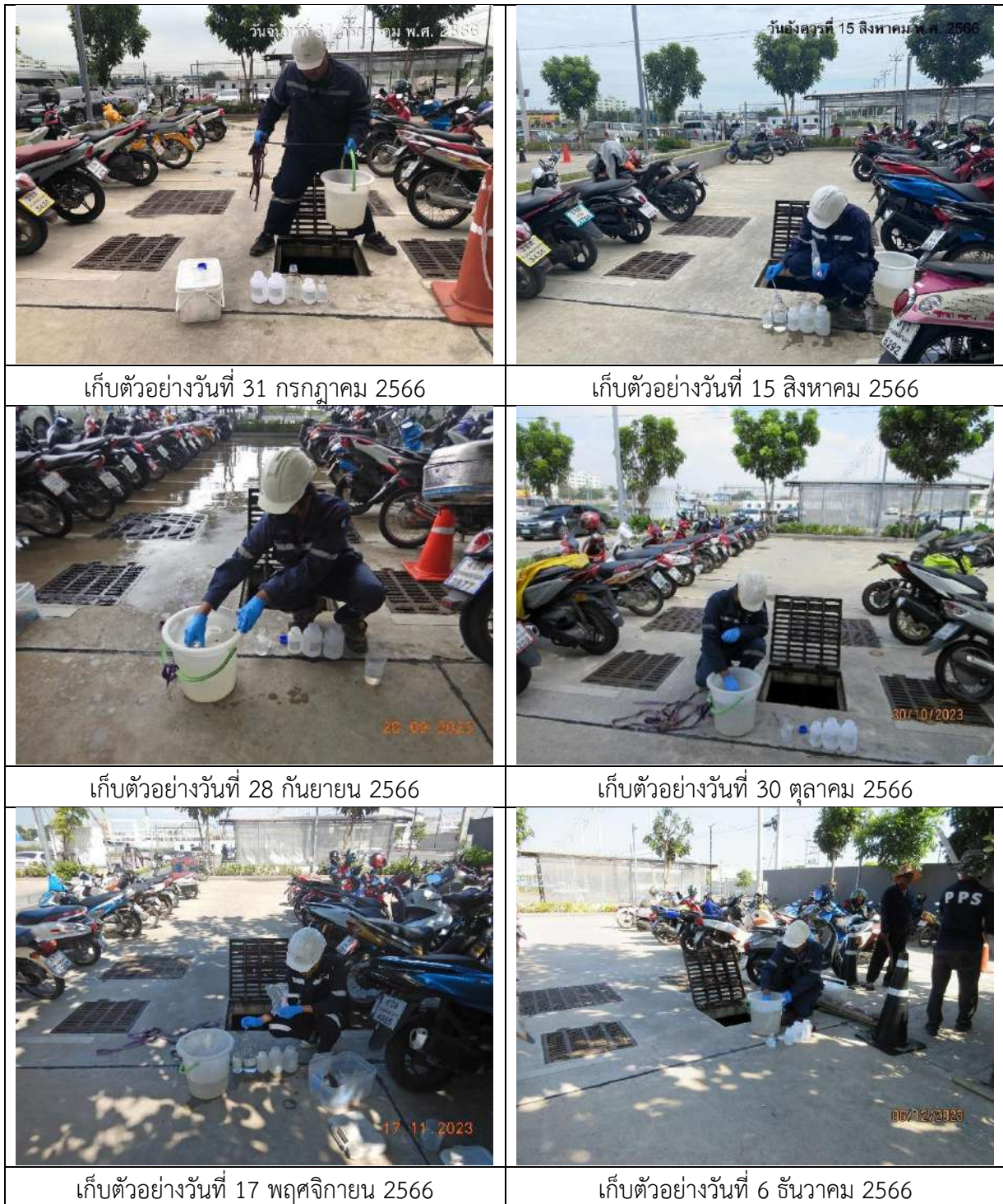
รูปที่ 3.5-2 ภาพถ่ายการเก็บตัวอย่างบริเวณจุดระบายน้ำออกจากระบบบำบัดน้ำเสีย
